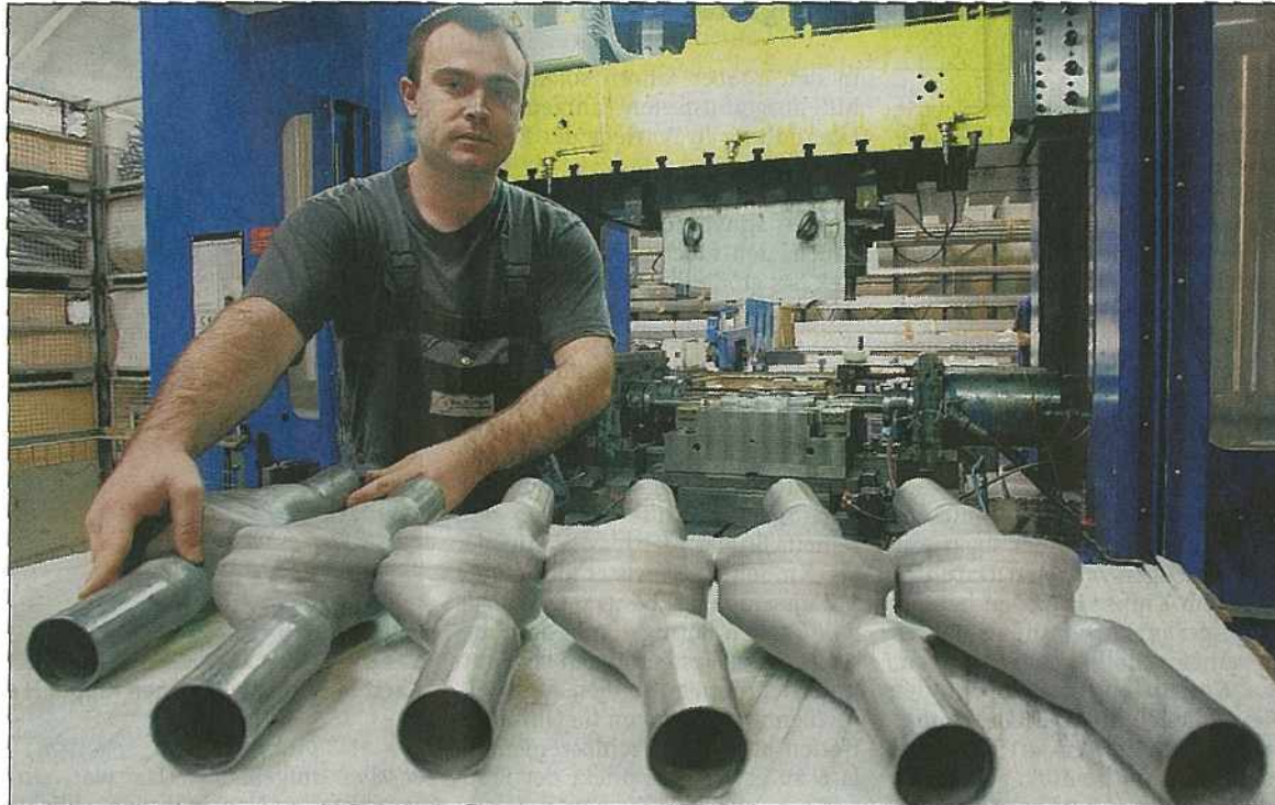
Hydroforming-Mitarbeiter Lars Reichelt presst Teile für Pkw-Abgasanlagen. Sie entstehen in Crimmitschau ebenso zum Beispiel wie Fahrwerksteile.
