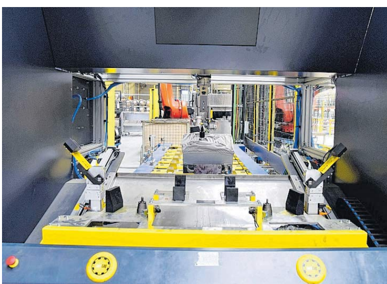
Bei Salzgitter Hydroforming entstehen in solchen Pressen besonders stabile Bauteile aus Metall. Dazu werden die Rohlinge mit Wasser gefüllt und dann verschlossen, sodass der Druck die Teile von innen in die Form drückt.
